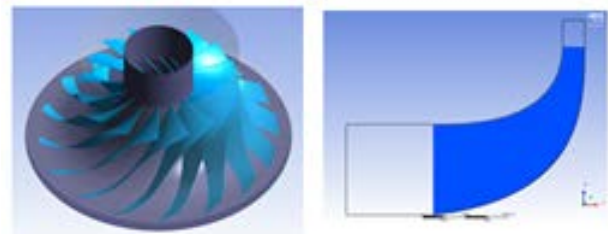
Hình 7. Mô phỏng 3D và mặt cắt máy nén.
