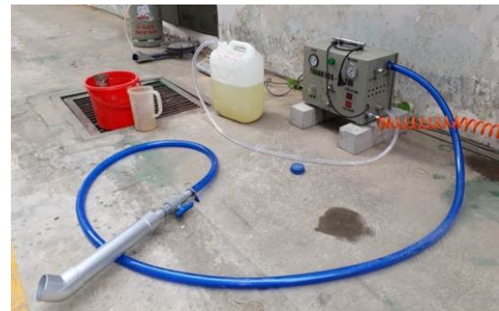
Hình 5. Hệ thống máy tạo bọt.
