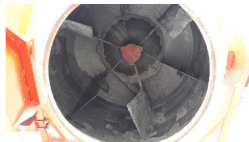
Hình 7. Máy trộn được hàn thêm cánh trộn.
