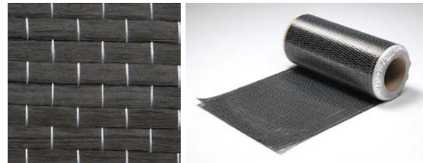
Hình 1. Cấu tạo vật liệu composite gia cường.
