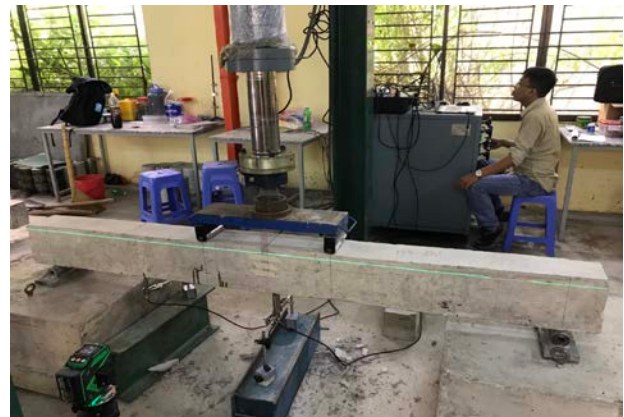
Hình 11. Hình ảnh đo chuyển vị dầm bê tông cốt thép khi chịu tải trọng tại phòng thí nghiệm.
