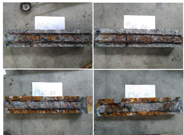
Hình 12. Cốt thép bị ăn mòn sau khi ngâm.
