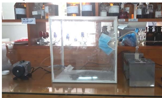
Hình 1. Mô hình thí nghiệm với buồng giả lập môi trường bụi.
