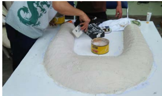
Hình 10. Tạo hình phao bằng matit.
