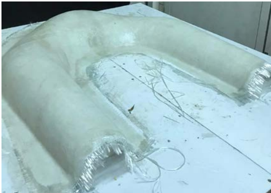
Hình 13. Đắp nhựa composite tạo khuôn âm.
