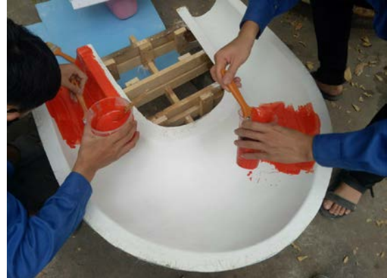
Hình 16. Phủ lớp tạo bề mặt sản phẩm.
