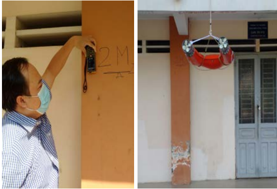
Hình 23. Thử rơi 2 m trên sàn bê tông.
