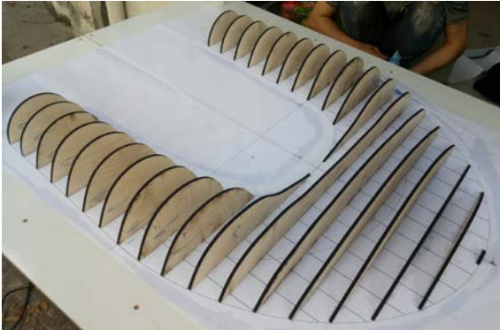
Hình 8. Chi tiết phao đã cắt CNC.
