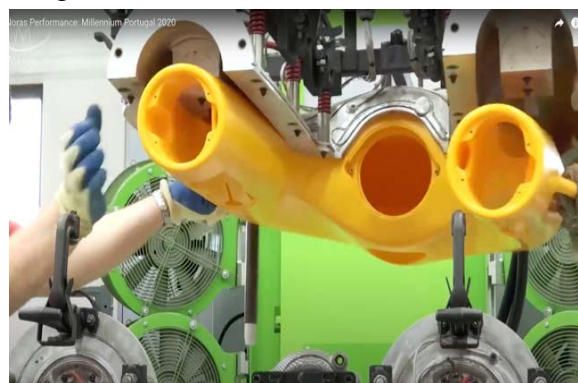
Hình 7. Phao cứu sinh chế tạo bằng HDPE [16].
