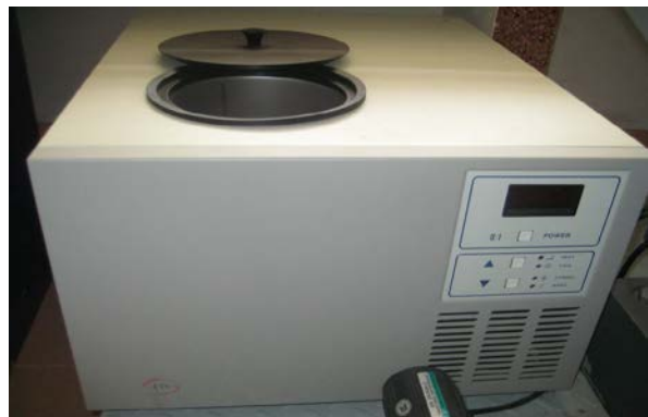
Hình 5. Thiết bị làm lạnh mối hàn cho thử va đập.
