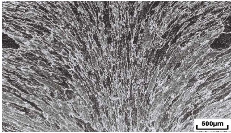
(b) Tổ chức tế vi kim loại mối hàn A572 với 600A và 7 mm/s.
