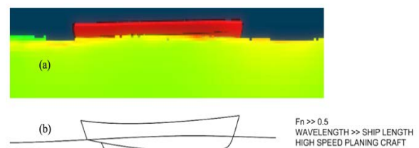
Hình 22. So sánh hình ảnh sóng tàu mô phỏng (a-phóng to) với sóng lý thuyết (b).
