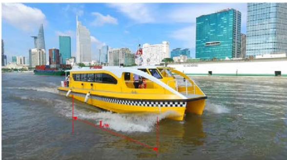
Hình 18. Hình ảnh thực tế sóng nước tàu buýt sông tạo ra khi chạy.
