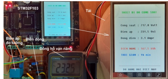
Hình 8. Thử nghiệm khâu đo dòng/áp/công suất trên mô hình vật lý.
