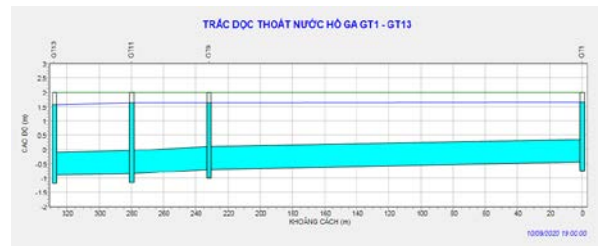
Hình 11. Kết quả mô phỏng dòng chảy từ GT1 đến GT13.
