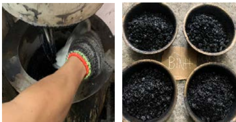
Hình 6. Hình ảnh tạo mẫu bê tông nhựa.
