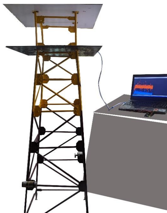
Hình 1. Kết nối phần cứng mô hình OJP với máy tính trong phòng thí nghiệm.
