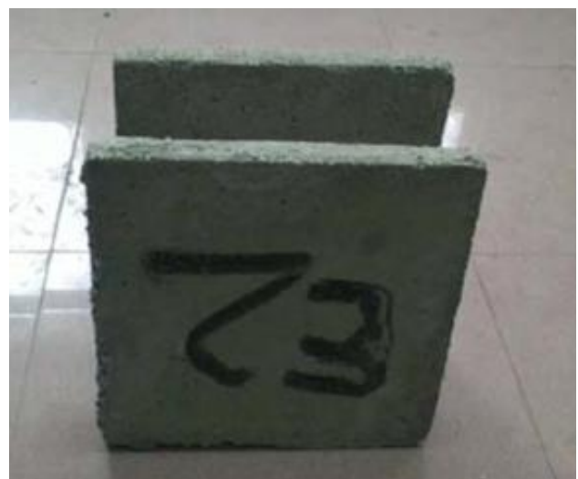
Hình 2. Mẫu thí nghiệm LEPS-C [3].
