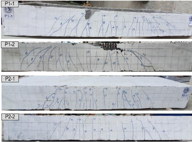
Hình 6. Cấu trúc vết nứt của mẫu thí nghiệm P1 (gió hút) và P2 (gió đẩy).
