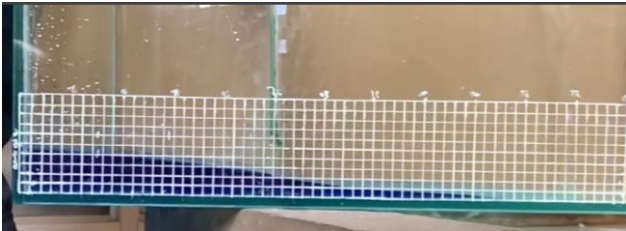
Hình 1. Đường tung độ mặt nước tại thời điểm 0,25 s cho trường hợp chiều cao cột nước ban đầu 6 cm của thí nghiệm vật lý.
