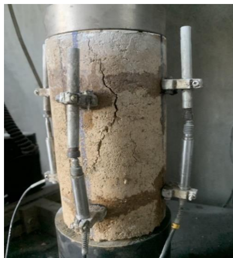
Hình 6. Thí nghiệm xác định mô đun đàn hồi của đất nện.
