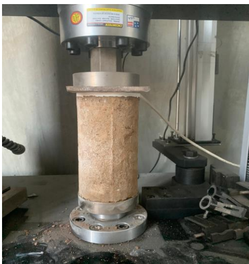
Hình 5. Thí nghiệm xác định cường độ chịu nén của đất nện.
