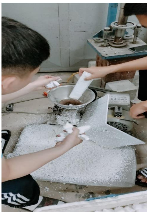
Hình 1. Công tác nghiền xốp phế thải tại phòng thí nghiệm
