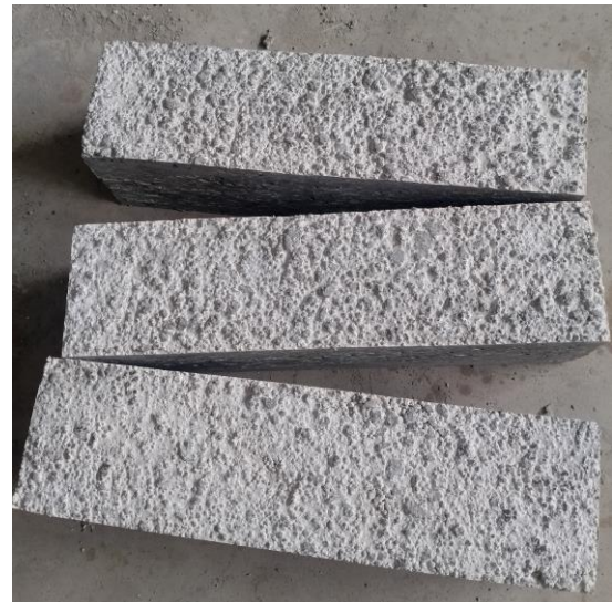
Hình 6. Chế tạo mẫu xác định cường độ chịu kéo khi uốn của REPSC.
