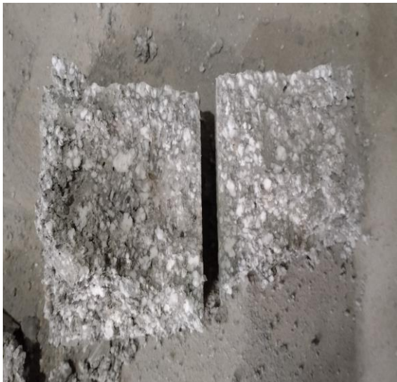
Hình 5. Mẫu REPSC bị phá hoại sau thí nghiệm xác định cường độ chịu nén.
