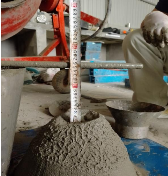
Hình 3. Thí nghiệm xác định độ sụt của hỗn hợp bê tông.
