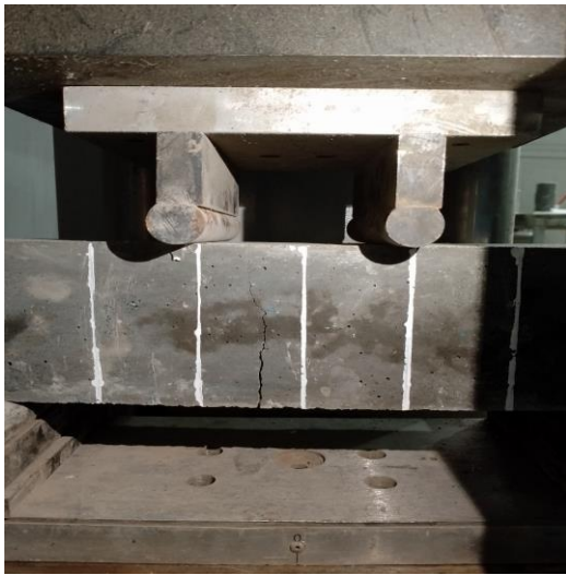
Hình 7. Thí nghiệm uốn 4 điểm xác định cường độ chịu kéo khi uốn của REPSC
