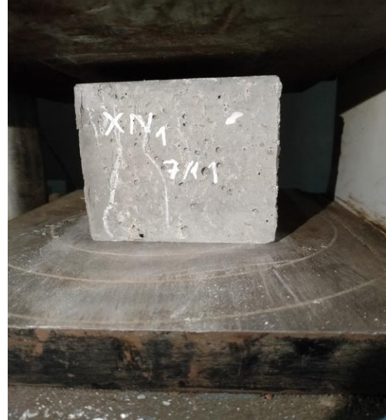
Hình 4. Thí nghiệm xác định cường độ chịu nén của REPSC.
