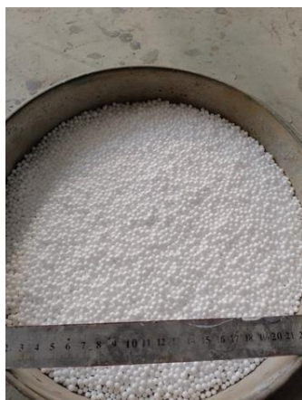
Hình 2. Hạt EPS chế tạo bê tông.
