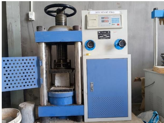
Hình 3. Thí nghiệm xác định cường độ chịu nén của SFRC.
