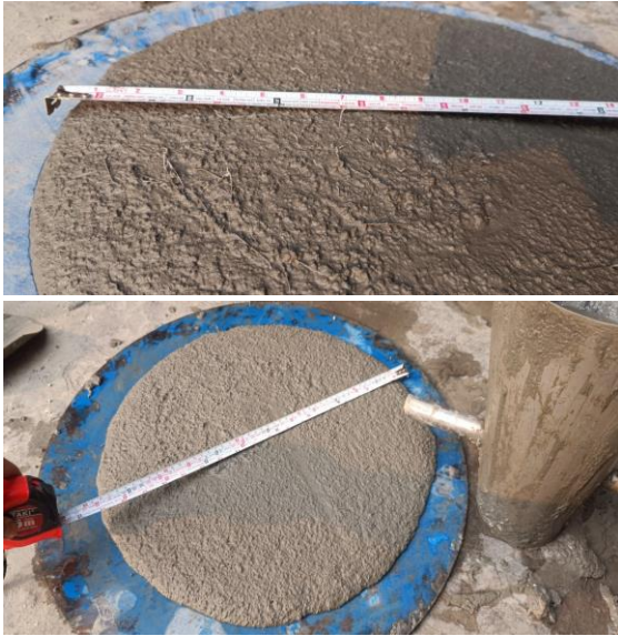
Hình 2. Thí nghiệm xác định độ chảy loãng của hỗn hợp bê tông.
