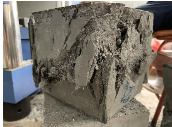
Hình 4. Mẫu SFRC bị phá hoại sau thí nghiệm xác định cường độ chịu nén.
