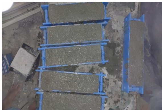
Hình 5. Chế tạo mẫu xác định cường độ chịu kéo khi uốn của SFRC.
