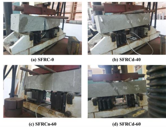
Hình 9. Dạng phá hoại của các mẫu dầm.
