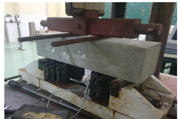
Hình 6. Thí nghiệm uốn bốn điểm xác định cường độ chịu kéo khi uốn của SFRC.
