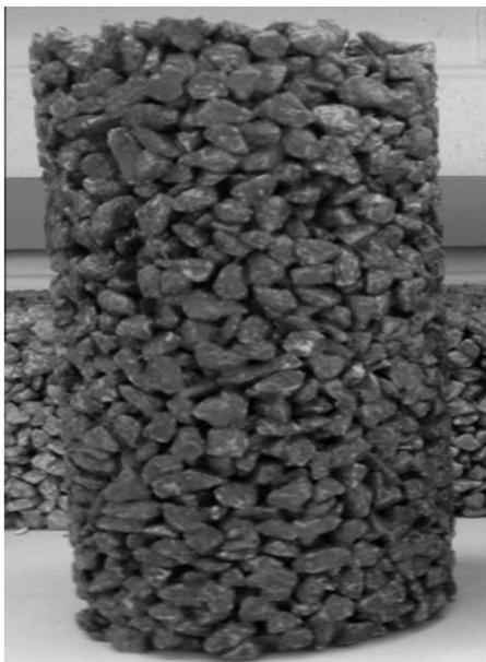
Hình 1. Mẫu bê tông rỗng.
