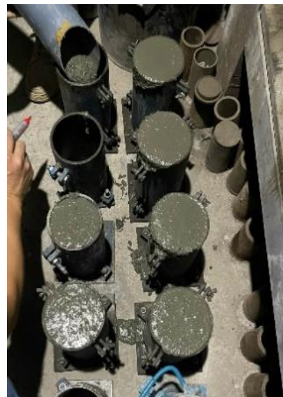
(b) Quá trình đổ bê tông.
