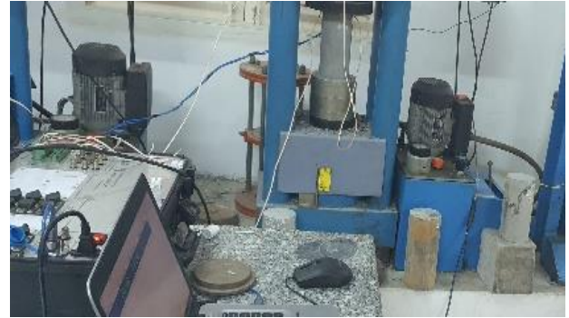
(b) Thí nghiệm xác định đường cong ứng suất nén-biến dạng.
