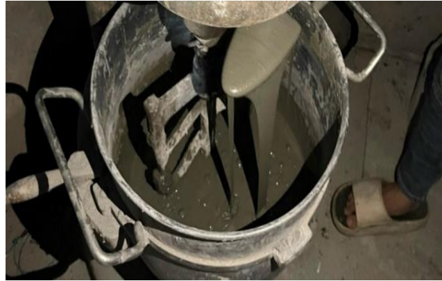
Hình 1. Thiết bị trộn cường bức 04 cấp độ tại phòng thí nghiệm.
