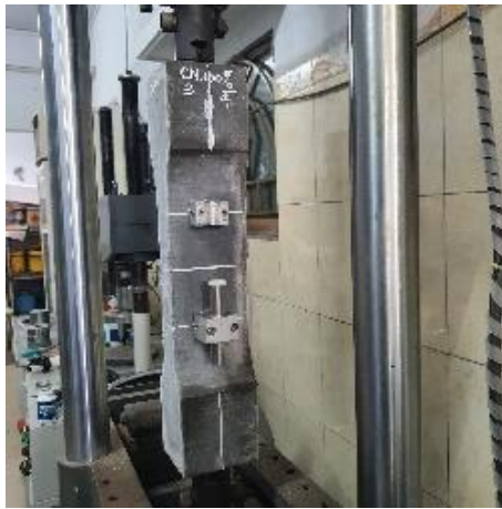
(a) Lắp đặt mẫu và LVDT.
