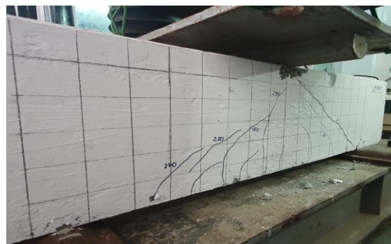
Hình 7. Cấu trúc vết nứt của dầm đối chứng.
