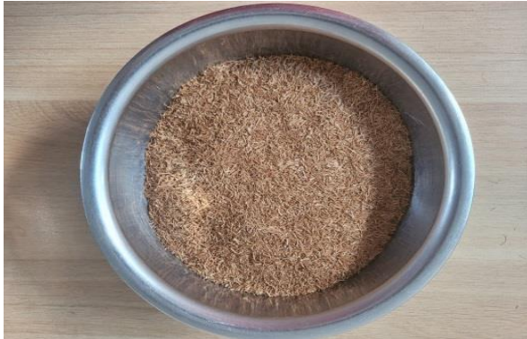
Hình 1. Sợi xơ dừa được cắt với kích thước 3 - 5 mm.
