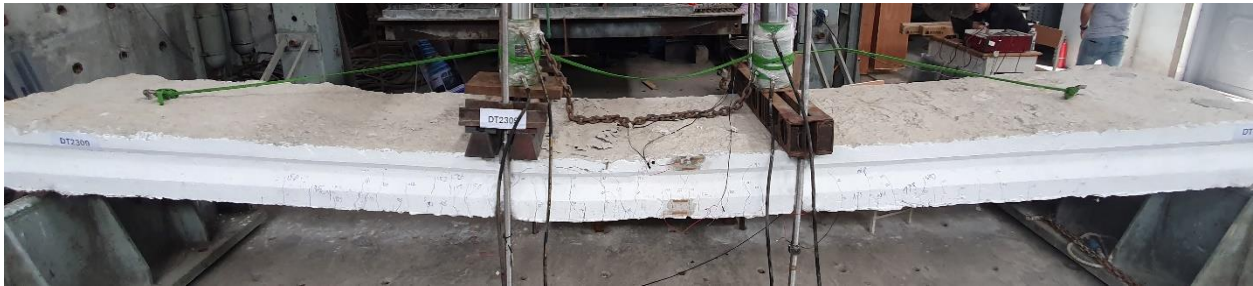
Hình 6. Dạng phá hoại và cấu trúc vết nứt.
