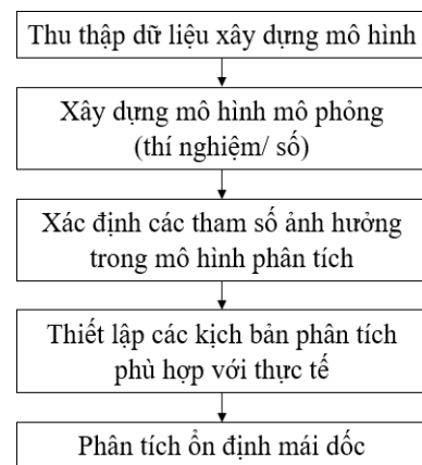
Hình 1. Quy trình tổng quát phân tích ổn định của mái dốc bằng mô hình mô phỏng.
