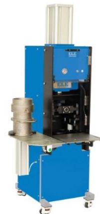
Hình 2. Thiết bị đầm xoay để chế tạo mẫu bê tông nhựa.
