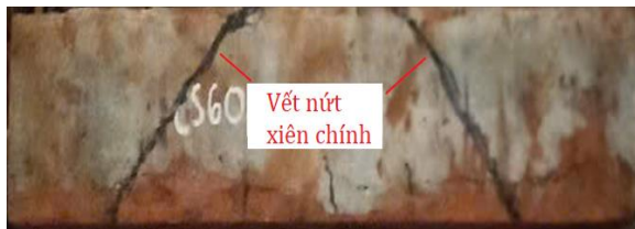
Hình 7. Hướng phát triển vết nứt của dầm chịu uốn bị ăn mòn: (a) Thực nghiệm; (b) Mô phỏng.
