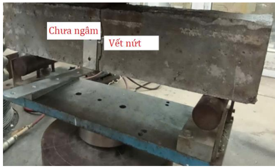
Hình 6. Hướng phát triển vết nứt của dầm chịu uốn chưa ăn mòn: (a) Thực nghiệm; (b) Mô phỏng.
