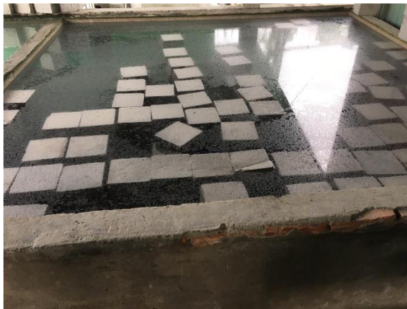
Hình 1. Bảo dưỡng mẫu bê tông.
