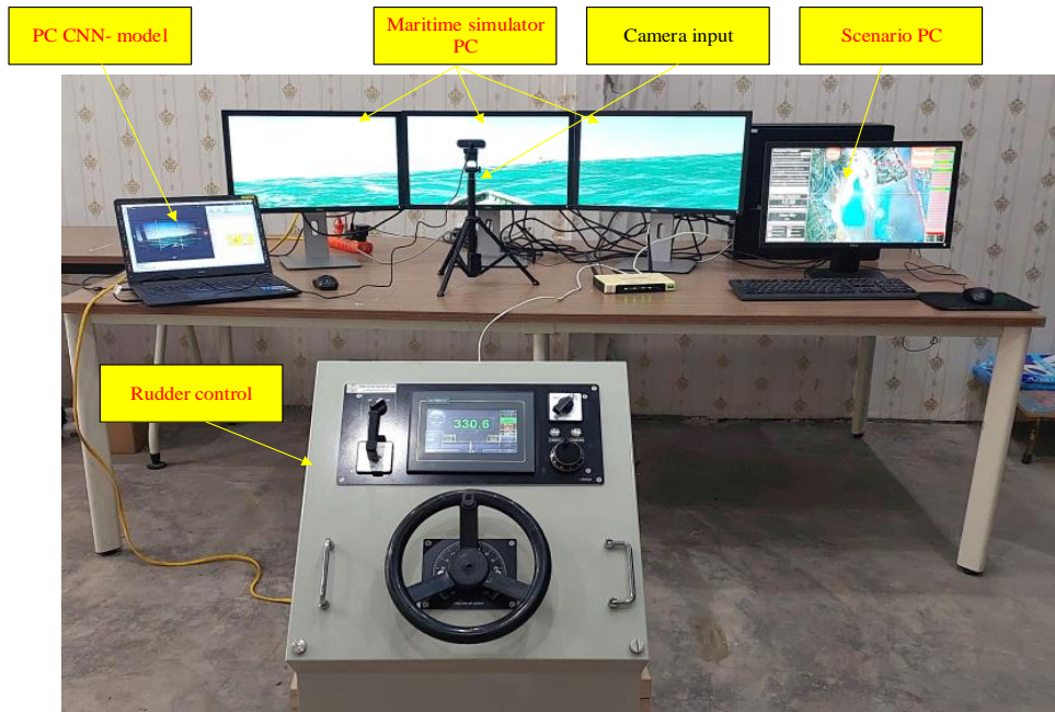
Hình 5. Mô hình hệ thống điều khiển dựa trên hệ thống lái thực và phần mềm mô phỏng.
