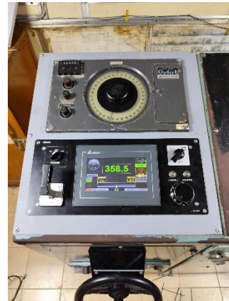
Hình 4. Hệ thống lái tàu. (a) Lắp đặt trên tàu. (b) Thử nghiệm thực tế.
