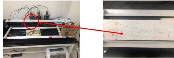
Hình 7. Sợi quang FBG được gắn trên dầm thép trong phòng thí nghiệm.
