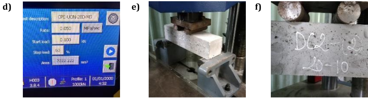
Hình 4. Quá trình nén và uốn mẫu HPC. (a) Bảo dưỡng mẫu HPC, (b) Gia tải nén, (c) Mẫu nén, (d) Cấp gia tải, (e) Gia tải uốn, (f) Mẫu uốn.
