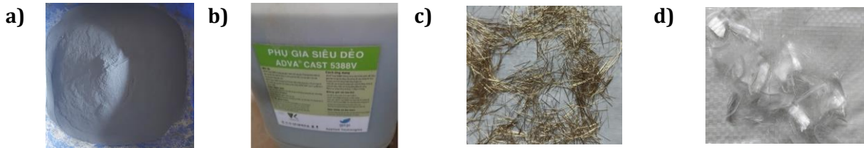
Hình 1. Phụ gia và cốt sợi trong bê tông HPC. (a) Silicafume, (b) Phụ gia siêu dẻo ADVA, (c) Sợi thép thẳng (straight steel fibers), (d) Sợi tổng hợp (polypropylenen fibers).
