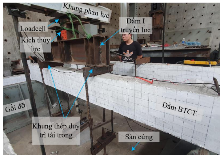
Hình 4. Gia tải gây nứt, và duy trì tải trọng trong quá trình thi công sửa chữa dầm.
