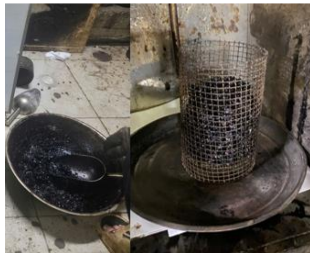
Hình 3. Thí nghiệm độ chảy nhựa.
